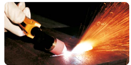
Plasmafugen mit dem Handbrenner PB-S45 WH Plasma gouging with hand torch PB-S45 WH
